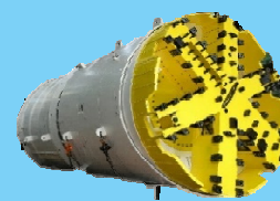
シールド掘進機
